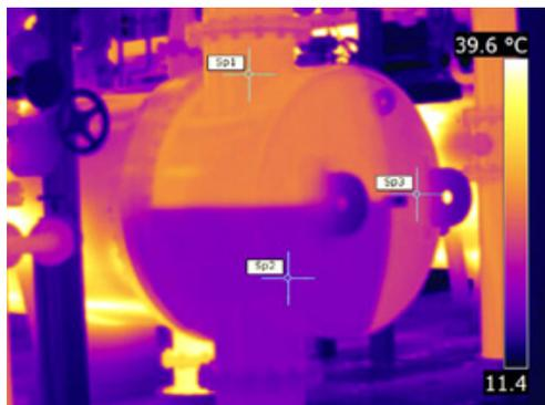
**Abb. 4** Kontrolle der Funktion von Stoffströmen und Umlenklechen an einem Wärmetauscher. Die Funktion ist hier einwandfrei erkennbar. Die Dichtungen an den Umlenklechen sind in Ordnung.
