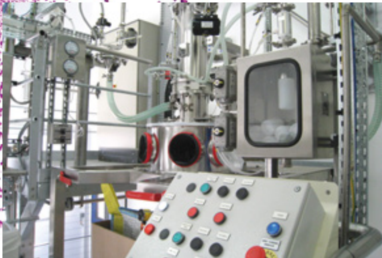
Abb.1 Big-Bag-Befüllung mit DCS und PTS System, ideal zur Trocknerentleerung mit Onlineprobenahme. Bild: © Dietrich Engineering Consultants
