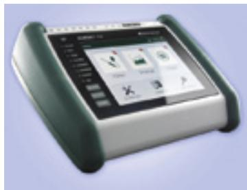
ALMEMO 710 ist ein echter Newcomer im Bereich applikationsunabhängiger Messgeräte. Der Datenlogger bietet modernste Gerätetechnik und eine hohe Messgenauigkeit. Ein zeitgemäßer Touchscreen sorgt für einen klaren Blick und eine intuitive Bedienung im Feld- oder Laboreinsatz.
