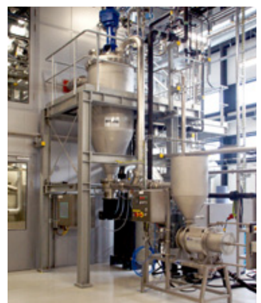
Abb.2 Teilansicht der Lignocellulose-Bioraffinerie Pilotanlage: Cellulosewaschtank (1400 L) zur Aufreinigung der Cellulosefasern inklusive Einheit zur Faserentwässerung.
