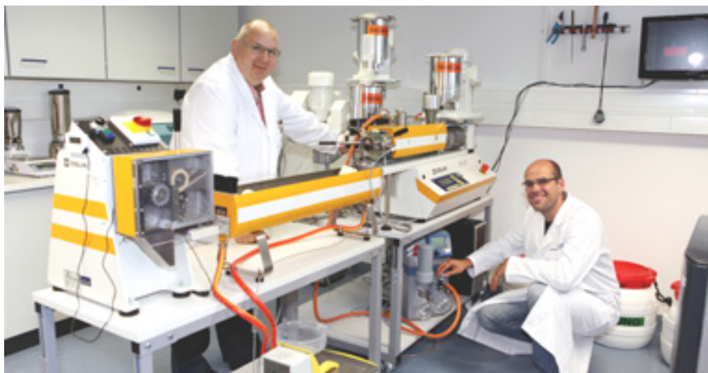
Laborextruder für die Erstellung von Marker-Masterbatches
