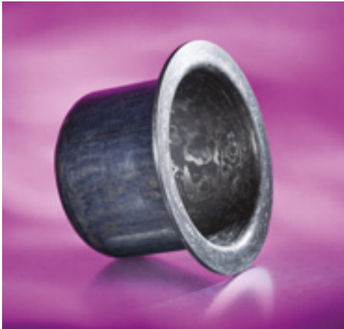
Abb. 5 Ein Spalttopf aus Xycomp® arbeitet ohne Wirbelstromverluste und dichtet den inneren gegen den äußeren Rotor hermetisch ab.
