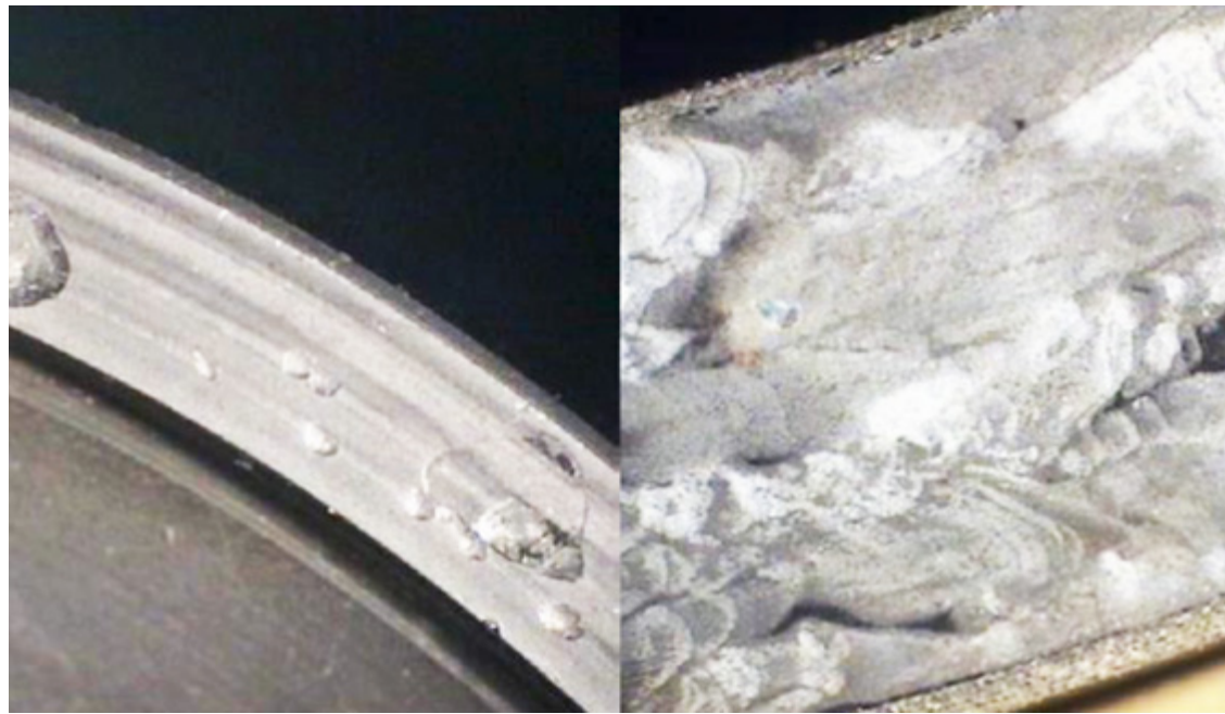
Abb. 1 Typische Schäden an herkömmlichen Gleitringdichtungen.
