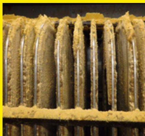
Ölhaltiger Filterkuchen nach Öffnen der Kammerfilterpresse
