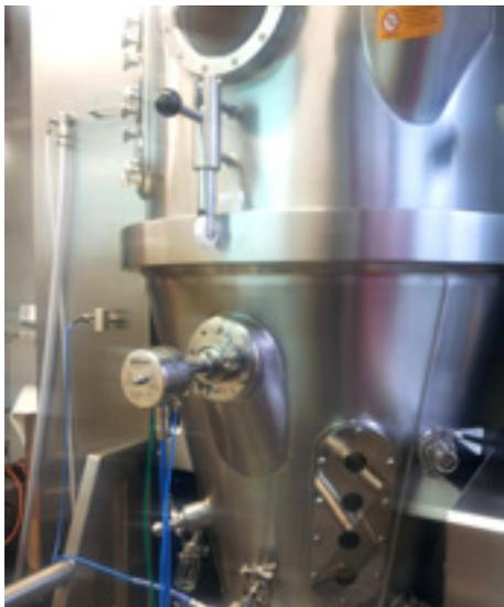
Das Wirbelschichtverfahren wird vor allem bei der Herstellung von Pressmassen zur Tablettenherstellung eingesetzt. Ein spezieller In-line-Dispergierer saugt die Partikel mit Druckluft an und führt sie durch das Messvolumen, wodurch die Partikel vereinzelt werden.
