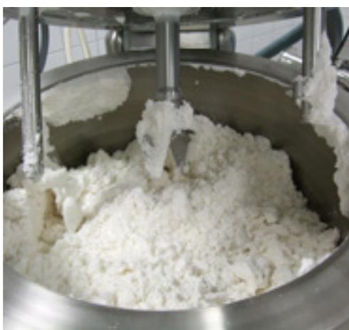
Das Messsystem wird auch bei der High-Shear-Granulierung eingesetzt, bei der das Material durch die Inline-Dispergierung trotz sehr hoher Feuchte messfähig bleibt. Dadurch lässt sich der Granulationsendpunkt zuverlässig bestimmen.
