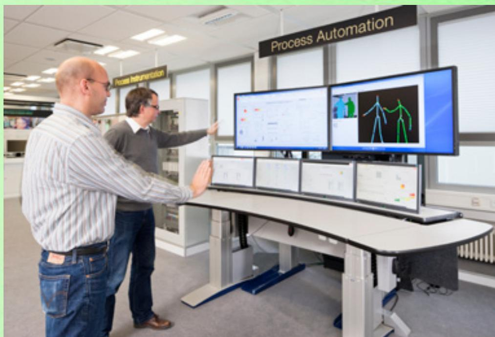
**Abb. 1** Gestensteuerung in Leitwarten ermöglicht es schnell zu Detailinformationen zu navigieren.
