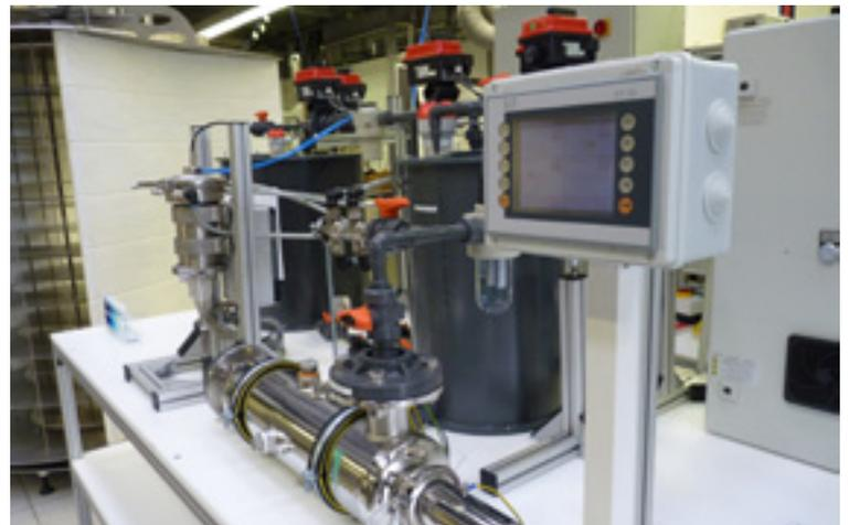
**Abb. 3** Im EU-Projekt Light4CleanWater entwickelter Prototyp zur VUV-Behandlung
