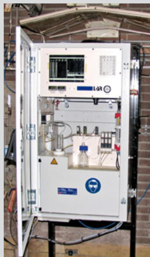
**QuickTOCcondensate in einem Kraftwerk**
