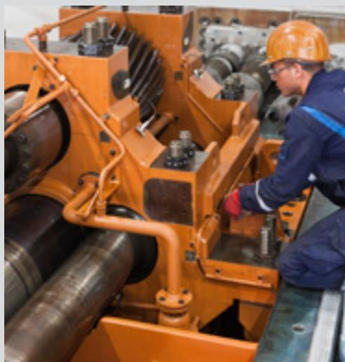
Zu den Equipments, die bei Stillständen chemischer Anlagen gewartet werden müssen, gehören unter anderem Extruder mit Getriebe.
