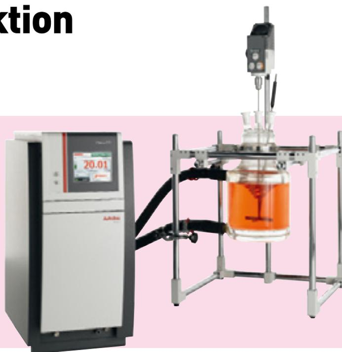
Mit den neuen PRESTO® bietet JULABO Spitzen-Technologie für moderne Labors an. Zur hochpräzisen Regelung von Temperaturen und zur Kompensation schneller Temperaturwechsel bieten die neuen PRESTO® 2,7kW Heizleistung. Die neuen PRESTO® sind äußerst robust und arbeiten selbst bei erhöhten Raumtemperaturen bis +40°C zuverlässig. Die integrierte Kältemaschine und das interne, gekühlte Expansionsgefäß fangen Volumenänderungen im Wärmetauscher permanent auf.
