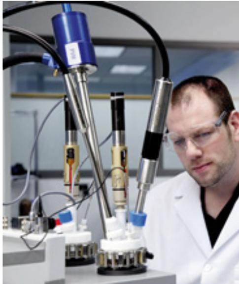
Versuchsanordnung für Experimente mit höchstem Informationsgehalt. EasyMax™ mit PVM®, FBRM® und ReactIR™ Sondentechnologie
