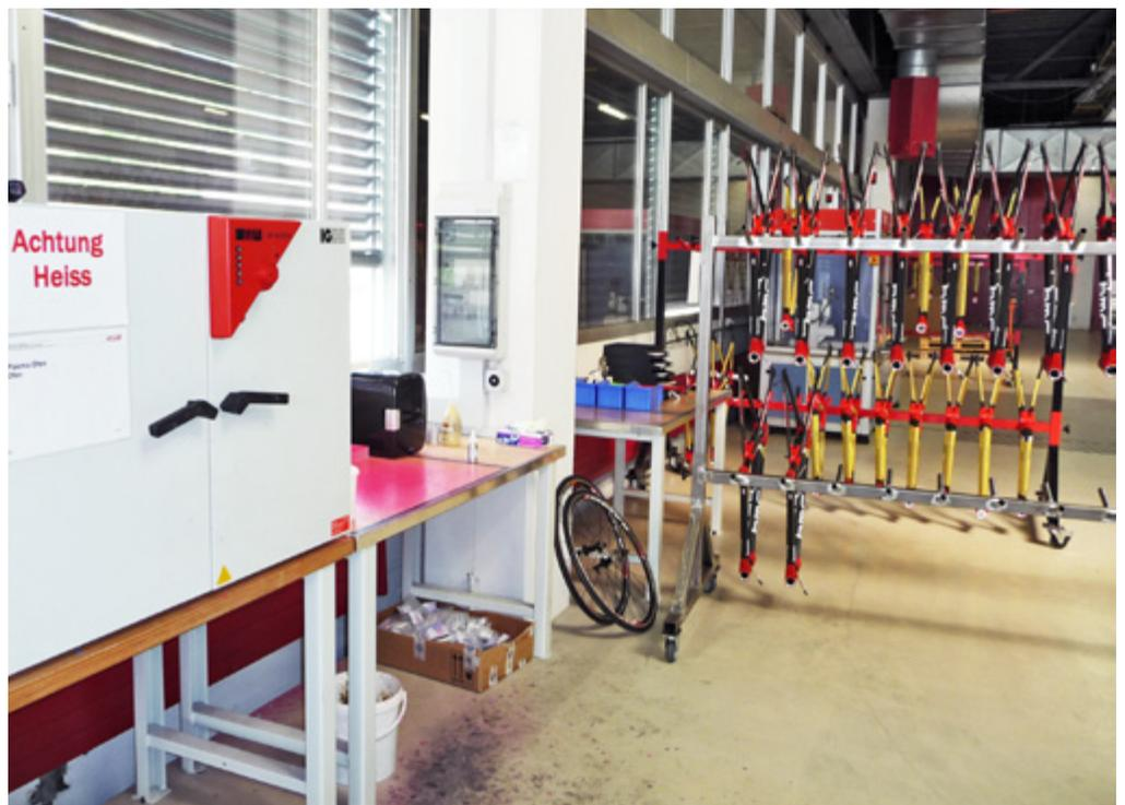
**Abb. 3** Carbonrohre werden in BINDER Trockenschrank FED gehärtet und getrocknet
