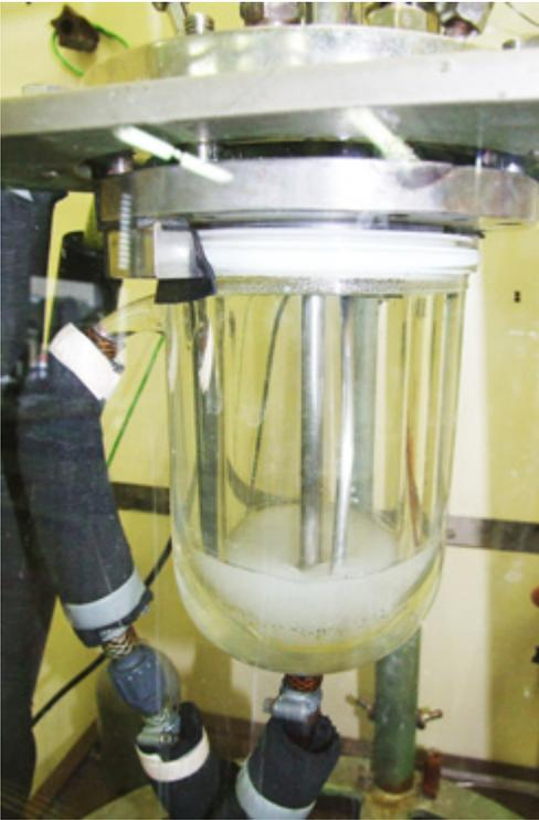
Abb. 2 Synthese von Polypropylencarbonat in CO<sub>2</sub>-Atmosphäre
