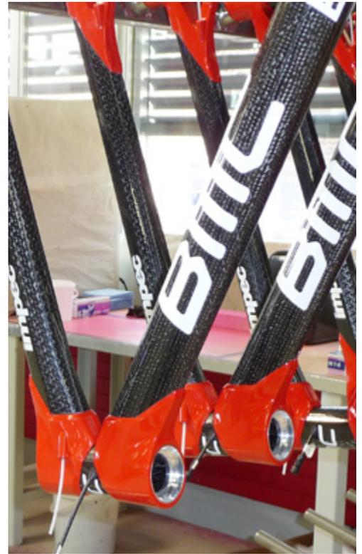
**Abb. 2** Fertiges Rahmenteil aus Carbon
