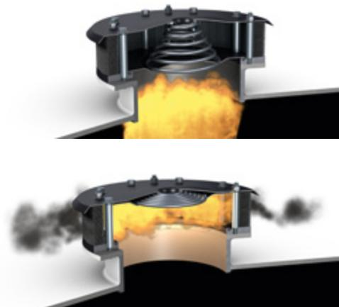
Abb. 3 und 4 Entlastungsventil für flammenlose Druckentlastung. oben: unmittelbar vor dem Ansprechen. unten: voll geöffnet
