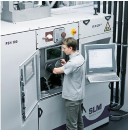
**Abb. 4** Durch das Laser-Schmelz-Verfahren ergeben sich einzigartige Gestaltungsmöglichkeiten der Formfindung und individuelles 3D-Drucken von komplexen Produkten.
