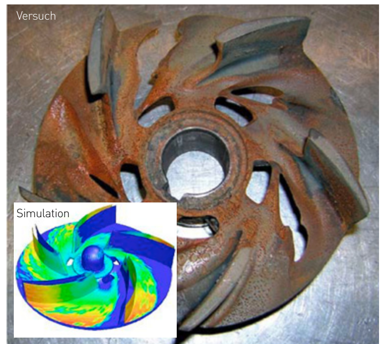
Abb. 3 und 4 Verschleiß-Simulation - Verteilung der Auftreffgeschwindigkeit der Partikel
