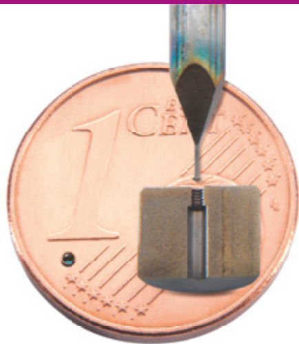
Zur diesjährigen SENSOR+TEST präsentierte Neuentwicklung der PTB: Taster mit Tastkugeldurchmessern von 120 µm bei der Messung eines Gewindes der Größe M0,7 x 0,175.
