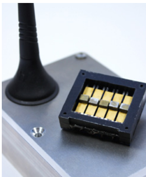
Piezogenerator-Array mit fünf frequenzabgestimmten Piezoschwingern auf einem energieautarken Zugpassage-Erkennungssystem. Im Sensorsystem ist ein ähnliches Array mit zehn Piezoschwingern integriert [2].
