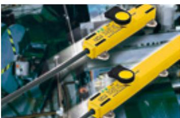
Resonator-Messprinzip, bei dem die Positionserfassung nicht über einen magnetischen Positionsgeber erfolgt, sondern induktiv über ein schwingfähiges System aus Kondensator und Spule. Der robuste LI-Q17 im vollvergossenen Kunststoffgehäuse wird jetzt in fünf Baugrößen angeboten.
