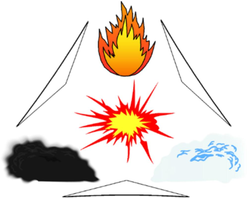
**Abb. 2** Eine Explosion kann nur ablaufen, wenn drei Faktoren zusammenkommen: brennbarer Stoff, Luft und Zündquelle
